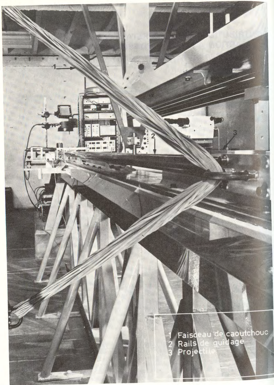
Figure 1: dispositif de traction à grande vitesse, dit ARBALETE (C.E.A., Centre de Bruyères-le-Châtel)
