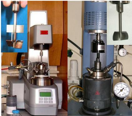
Fig. 1 : Rhéomètres MCR501 d'Anton Paar et AR2000 de TA Instruments équipés de cellule sous pression et leur géométrie respective en médaillon.
