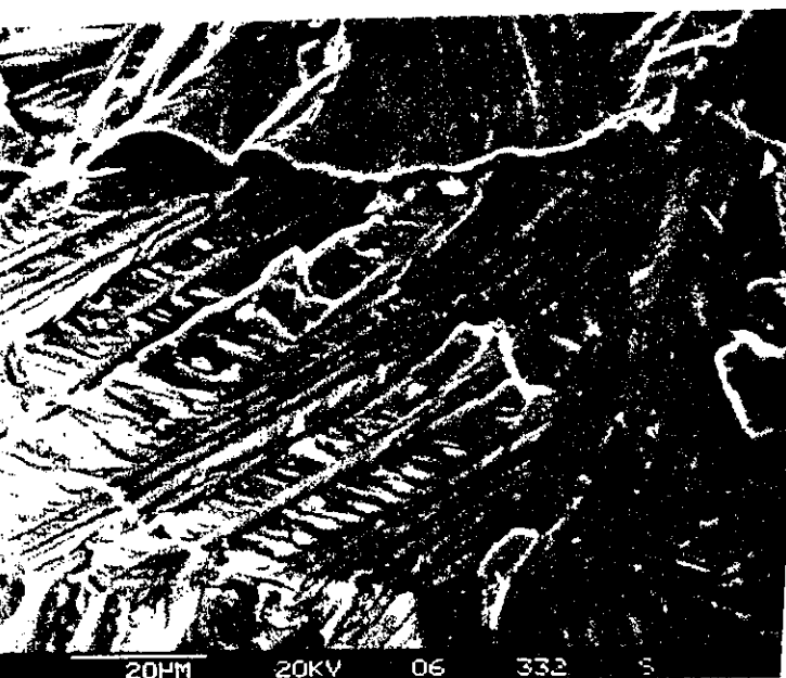
Figure 2 — Faciès de fissuration obtenu dans \text{MgCl}_2 44 % à 153^\circ\text{C} . pH et potentiel libres, essais à charge imposée.
