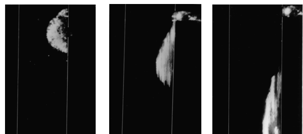
Figure 16. Marquage de l'écoulement en rhéométrie capillaire lors de l'écoulement d'un PDMS. L'index fluide injecté dans l'écoulement se déplace nettement au voisinage de la paroi, indiquant le déclenchement d'un glissement dans cette zone (publié avec autorisation d'après El Kissi, N.; Piau, J.-M.; "The different capillary flow regimes of entangled polydimethylsioxane polymers: macroscopic slip at the wall, hysteresis and cork flow", J. Non-Newt. Fluid Mech. 37, 55-94, 1990).
